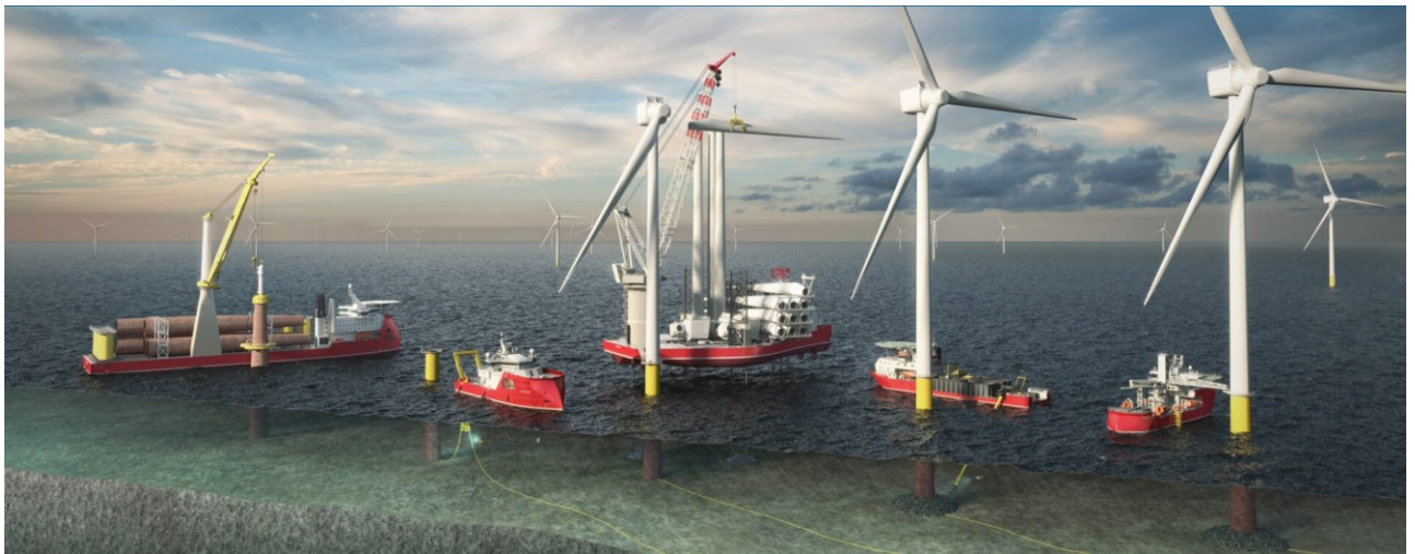
Εικόνα 6-2: Τύποι σκαφών που χρησιμοποιούνται κατά τη φάση κατασκευής, λειτουργίας και απεγκατάστασης ΥΑΠ (Ulstein, 2021)
